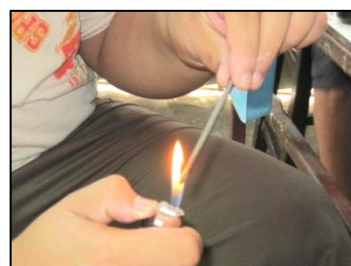
3.2 นำฝามาเจาะรูขนาดใหญ่กว่าสายยางเล็กน้อย โดยใช้ตะปูลนไฟให้ร้อน แล้วนำไปเจาะตรงกลางฝาวาด
