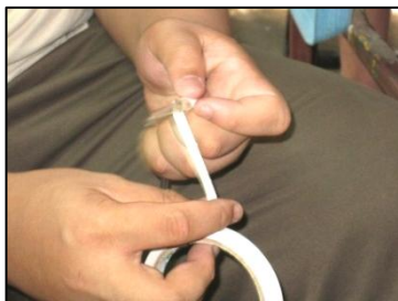
3.5 เสียบสายยางที่รูบนฝาขวด แล้วนำเทปใสติดสายยางให้ติดกับฝาขวดด้านในเพื่อไม่ให้สายยางเลื่อนไปมา
