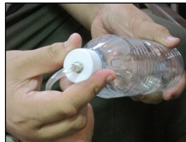
3.7 นำฝาขวดที่ต่อสายยางกับลูกบอลเด็กเล่นแล้ว ปิดขวดให้เรียบร้อย
