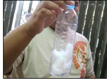
3.4 นำสำลีใส่ลงไปในช่วงให้สูงประมาณครึ่งขวด โดยไม่ต้องอัดแน่น
