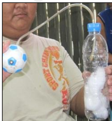
3.8 จะได้สื่ออุปกรณ์การเปรียบเทียบเขม่าควันรถยนต์
